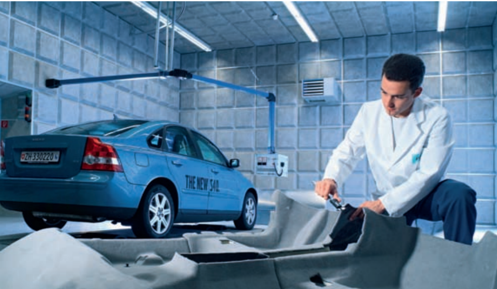
Savoir-faire suisse pour l'industrie automobile: mesure d'un tapis de voiture Rieter sur le banc d'essais acoustiques d'Automotive Systems Winterthour.
