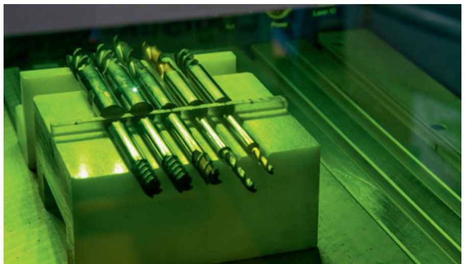
Markierung des Werkzeugs mit einem individuellen Datamatrixcode zur Identifikation im gesamten Produktionsprozess.
