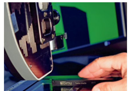
Optische Messung des Werkzeugprofils
