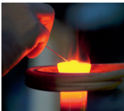
Ein Produktionsschritt ist das Einlöten von Hartmetalleinsätzen in die Führungsbüchsen
