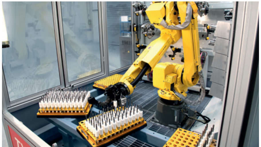
Vollautomatisches autonomes CNC-Schleifen mit werkzeugspezifischen Programmen.
