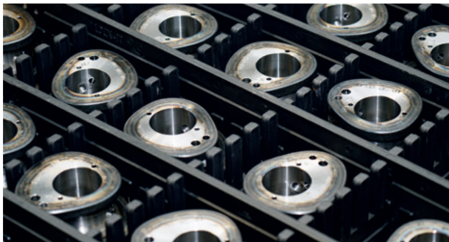
Die Steuerkurve ist das Herzstück einer LÄSSER Stickmaschine. Präzisionsbohrungen sind das A und O für den späteren Betrieb der Stickmaschine.
