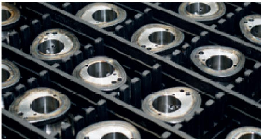
La came de commande est le cœur d'une machine à broder LÄSSER. Les perçages de précision sont la clé pour une utilisation ultérieure de la machine à broder.
