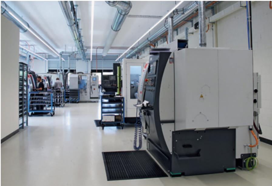
Erweiterung Softbearbeitung Bereich Rotation, 4- und 5-Achs-Maschinen, ausgerüstet mit Haupt- und Gegenspindel plus einer Frässpindel sowie Be- und Entladeroboter
