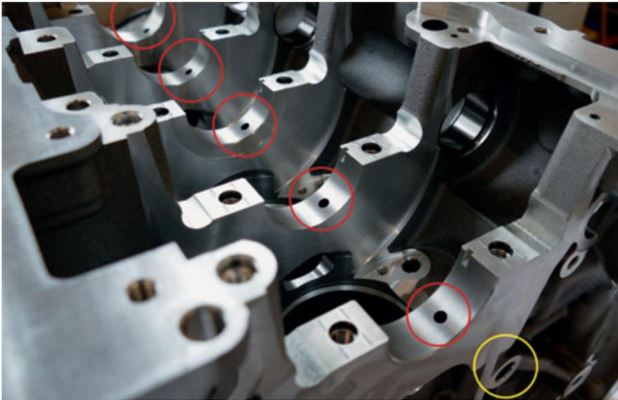
Kurbelgehäuse mit den zu entgratenden Bohrungen
