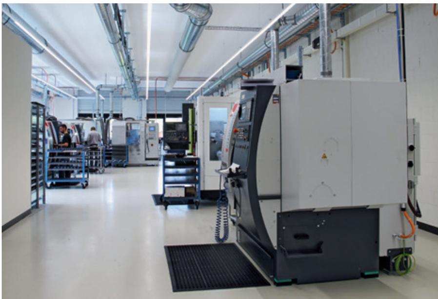
Expansion de l'usinage en douceur du secteur rotation, machines à 4 et 5 axes, équipées d'une broche principale et d'une contre-broche ainsi que d'une broche de fraisage et d'un chargeur et déchargeur automatique de l'usinage.
