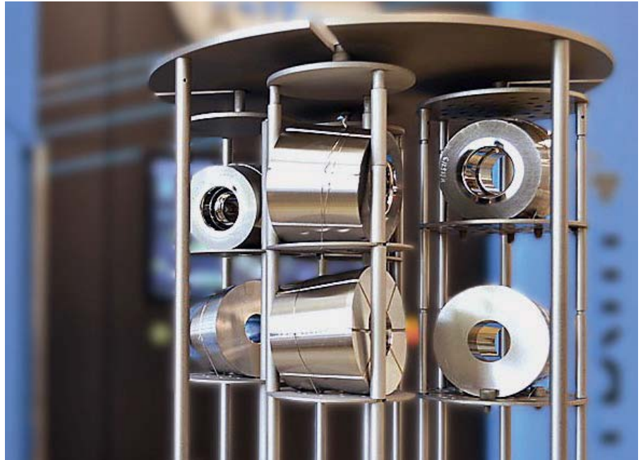
Pour obtenir une couche parfaitement uniforme, les pièces sont revêtues à l'aide d'un système de carrousel.
