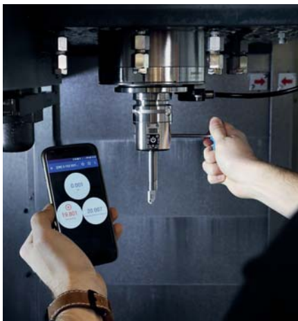
Une tête d'alésage numérique de précision avec connexion sans fil. Elle est réglée à l'aide d'une application sur le smartphone de l'utilisateur.
