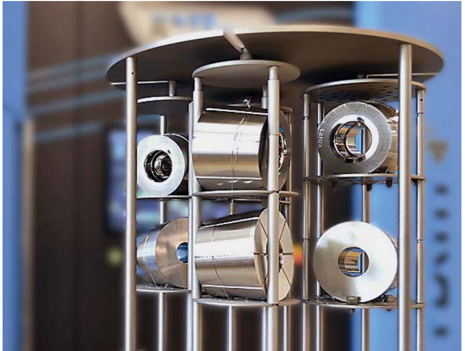
Für eine perfekt gleichmässige Schicht werden die Werkstücke in einem Karussell beschichtet.
