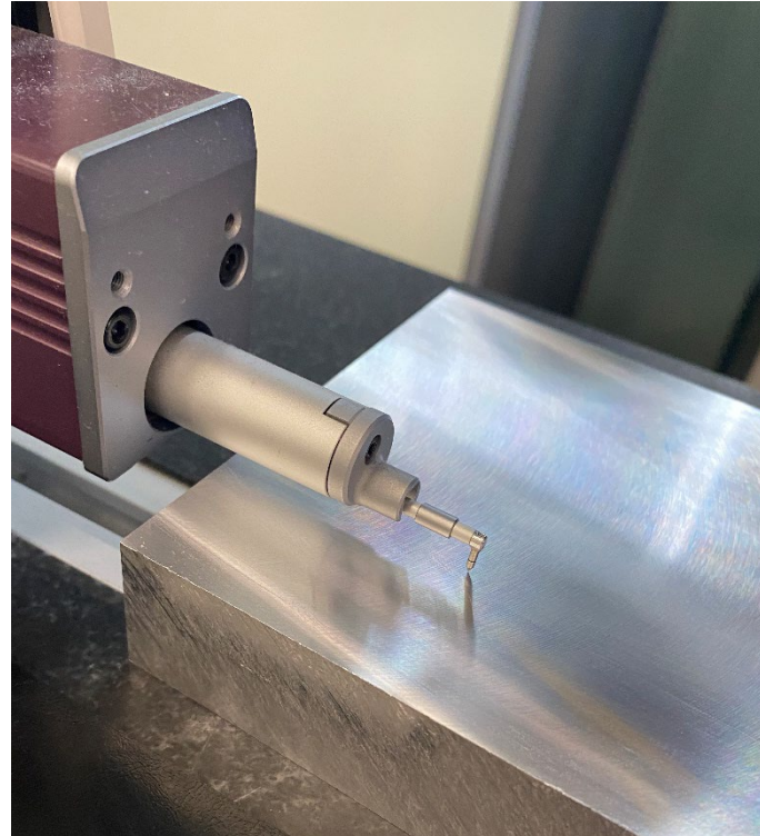
Oberflächengüte: Ra \sim 0.3\mu\text{m} Rz \sim 2.0\mu\text{m}
