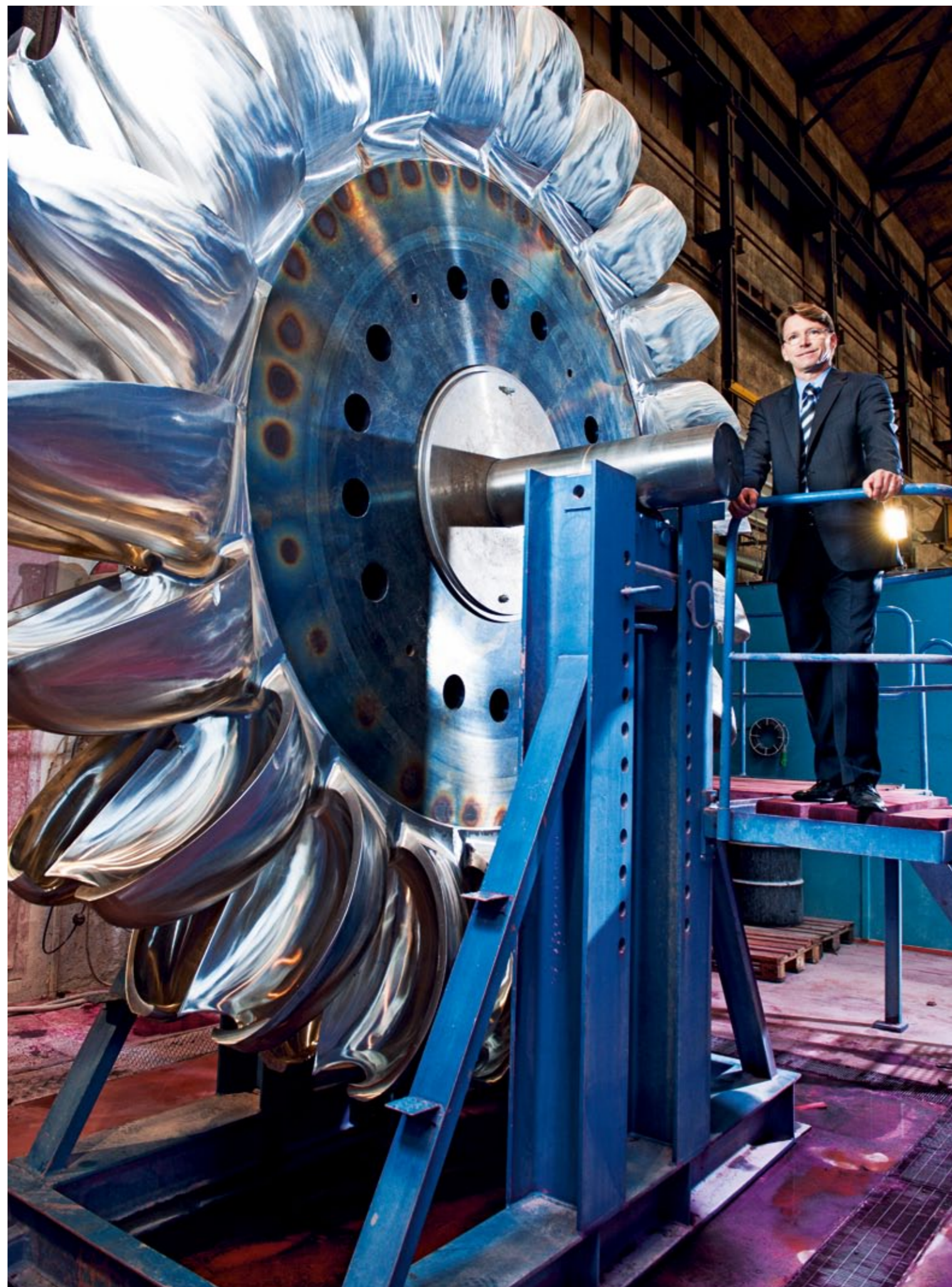
Co-Geschäftsführer Heinz Duner präsentiert eines der zahlreichen imposanten Pelton-turbinen-Laufräder, die bei Andritz Hydro hergestellt und gewartet werden.
