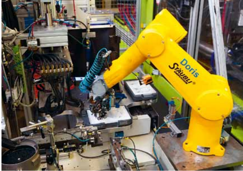
Blick in eine Montagezelle, wo ein Roboter eine Betätigungsplatte montiert.
