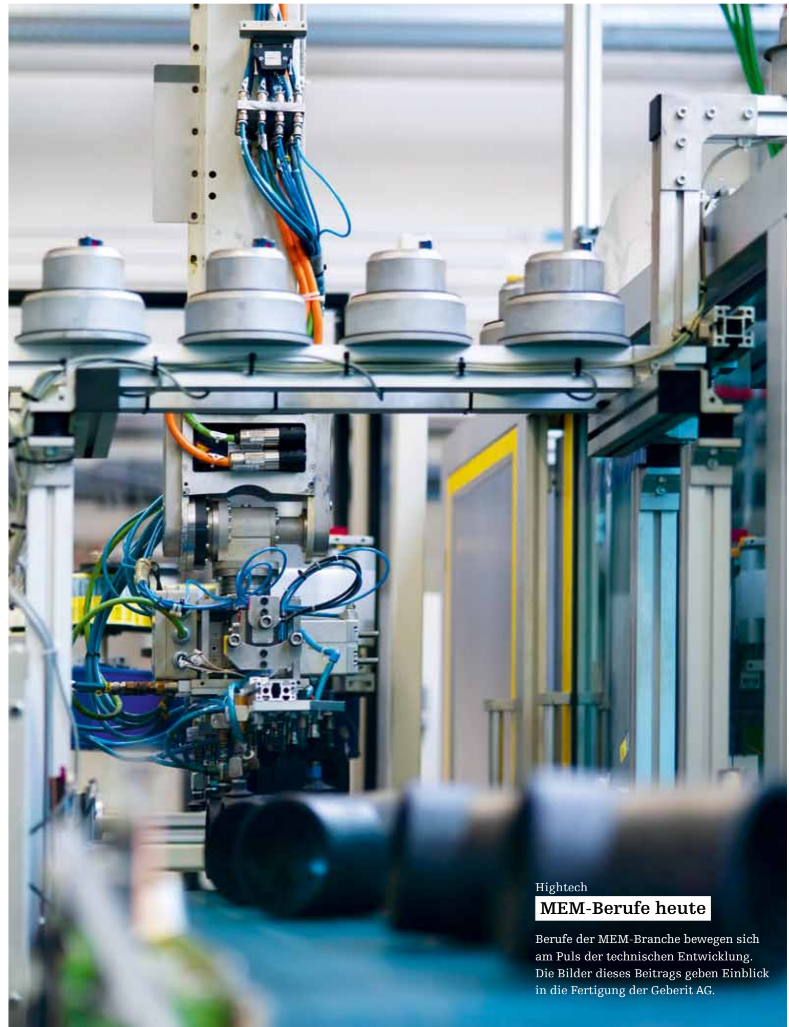
Blick in eine Automatisierungszelle, in der PE-Formstücke vollautomatisch hergestellt werden.
