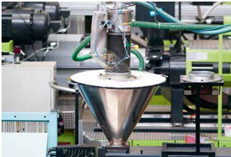
Dosierbehälter einer Spritzgussmaschine.
