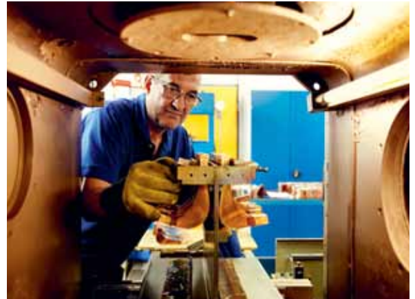
Der Schweissvorgang findet in einer Hochvakuumkammer statt.
