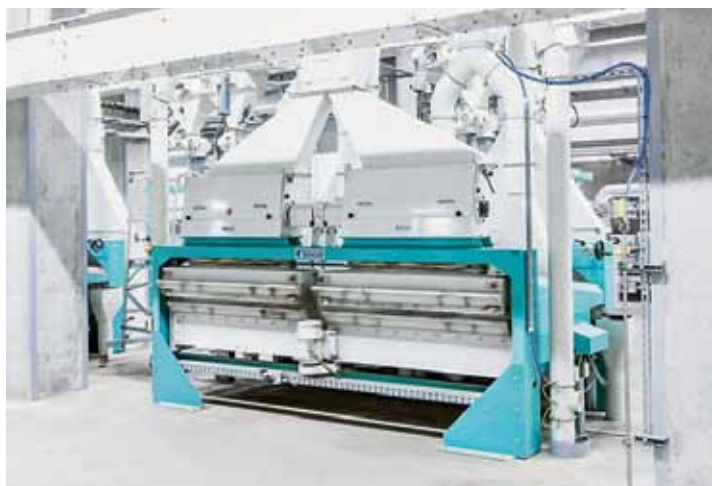
Schalenseparatoren trennen Ölsaaten von den Schalen, so z.B. bei Sonnenblumenkernen oder Sojabohnen.
