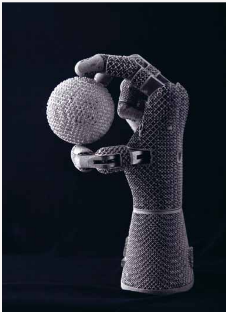
Ultraleichte Roboterhand aus Metall, die im 3-D-Druck gefertigt wurde.
