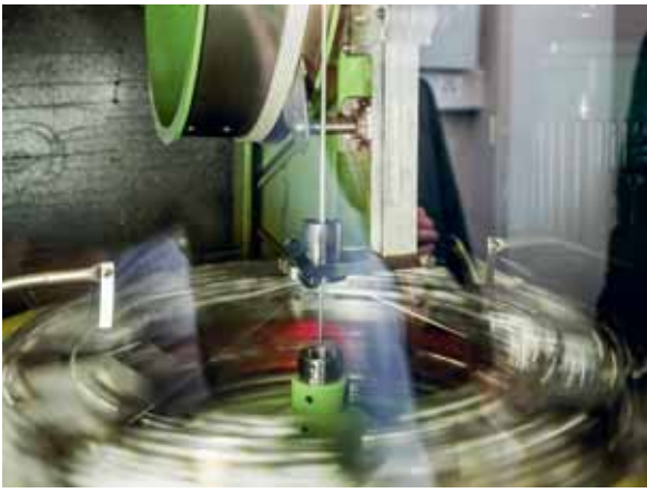
Eine Bandier-Anlage für Niederfrequenz-Kabel in der Produktion von HUBER+SUHNER.
