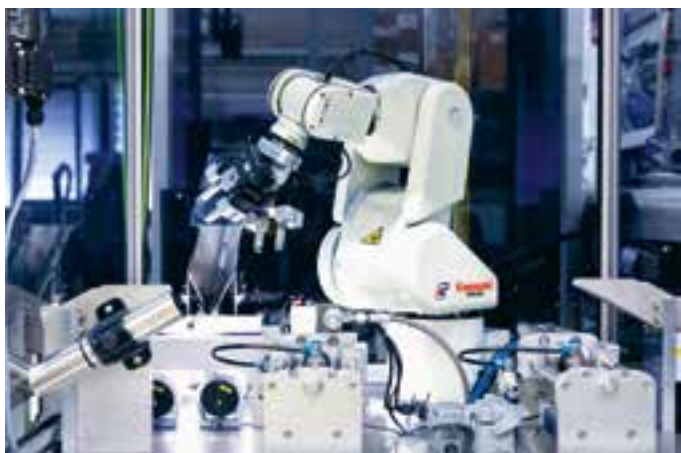
Die Zuverlässigkeit der Produkte ist meist sicherheitsrelevant. Im Bild: Eine Dichtheitsprüfanlage für Quick Connectors.
