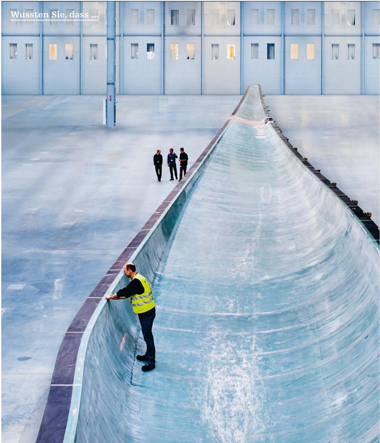
**... das Windturbinen-Rotorblatt B75 von Siemens die weltweit grösste Glasfaser-Komponente ist, die aus einem Guss hergestellt wird?** Es hat eine Länge von 75 Metern und ist Teil von Offshore-Windturbinen. Mit einem Rotordurchmesser von 154 Metern überstreichen diese eine Fläche von der Grösse von zweieinhalb Fussballfeldern (FIFA-Norm) – und fangen pro Sekunde die Energie aus 200 Tonnen Luft ein. – Im Bild: Die eine Hälfte der Gussform für das Rotorblatt B75 von Siemens.
