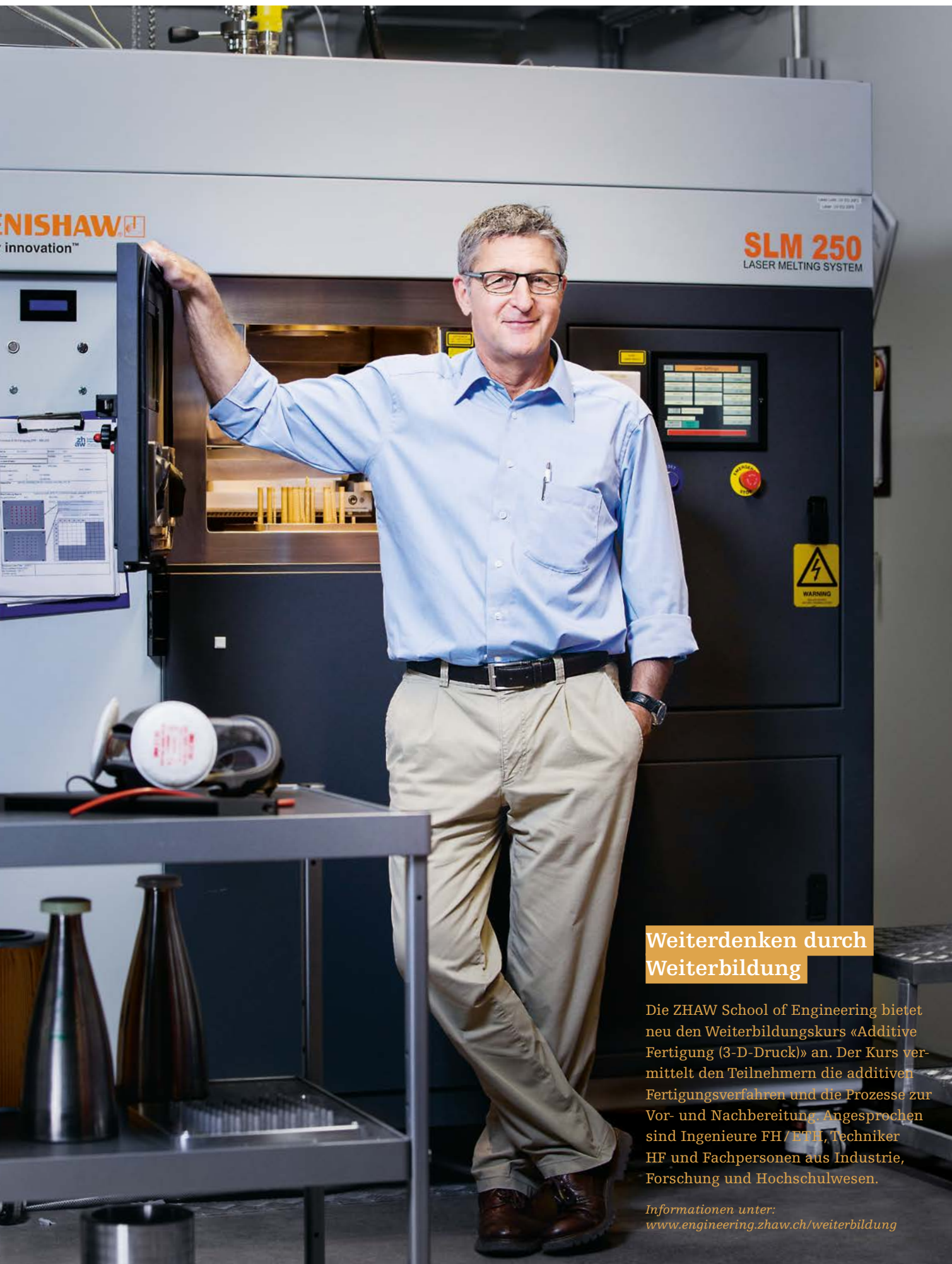
Andreas Kirchheim , Dozent für additive Fertigung, und sein Arbeitsgerät: eine SLM-Laserschmelzanlage für die additive Herstellung metallischer Teile.
