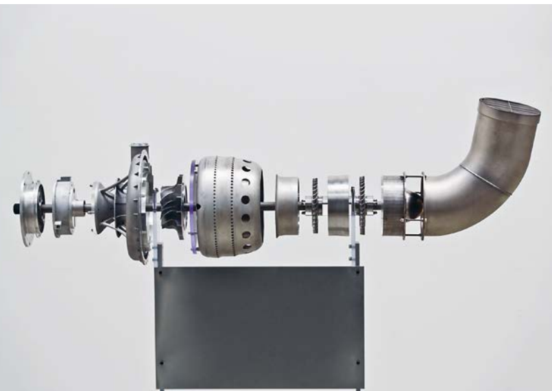
Ingenieure aus Australien haben es bereits geschafft, ein kleines Düsentriebwerk mit dem 3-D-Drucker zu produzieren. Es besteht unter anderem aus Titan, Aluminium und Nickellegierungen.
