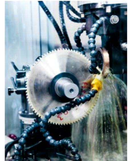
Oertli will mit hoher Drehzahl ins Jahr 2020 einfahren. Im Bild: Einer gebrauchten Diamantkreissäge wird zu alter Schärfe verholphen.
