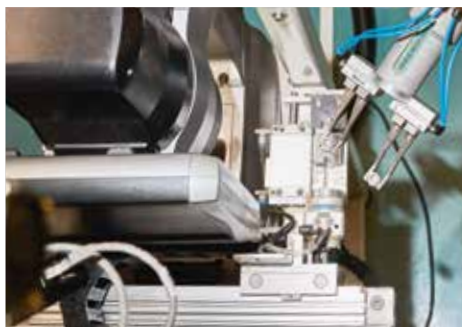
Oben: Die Quarzscheiben-Schleifmaschine wird während 24 Stunden über einen Roboterarm bedient. Unten: Die geschliffenen Quarzscheiben werden auf einem optischen Messsystem gemessen.
