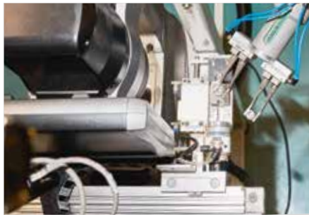
En haut: la meuleuse de disque de quartz est commandée par un bras robotique 24 heures sur 24. En bas: les disques de quartz sont mesurés à l'aide d'un système de mesure optique.
